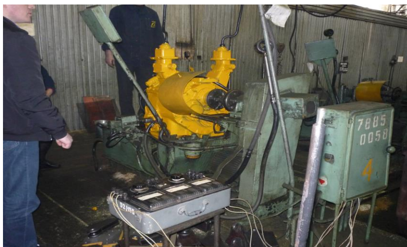
Рисунок 9 - Установленная на стенде коробка передач и прибор К-50 для измерения потребляемой мощности электродвигателем привода коробки
