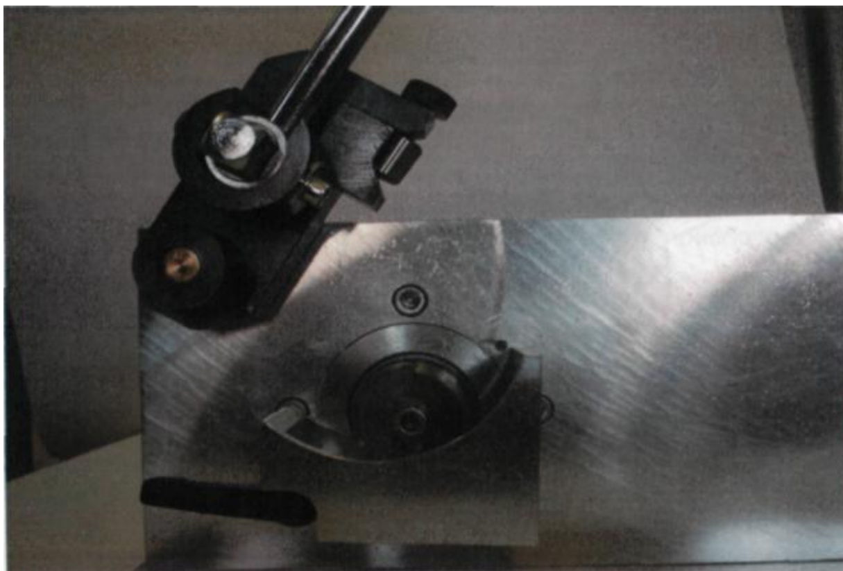
Рис. 8. Зажимное устройство образца-ролика, кольцо подшипника - контрообразец и съемная ванна для масла, содержащая наноматериал
