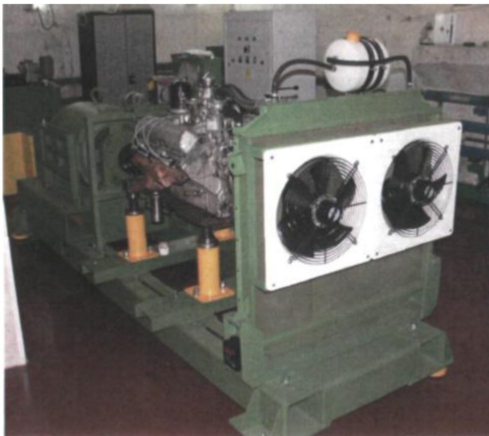
Рис. 19. Стенд КИ-5543 ГОСНИТИ для испытания дизельных двигателей
