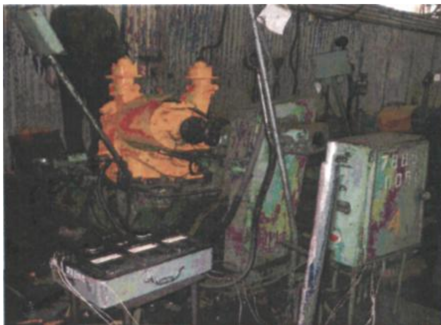
Рис. 21. Установленная на стенде коробка передач и прибор К-50 для измерения потребляемой мощности электродвигателем привода коробки
