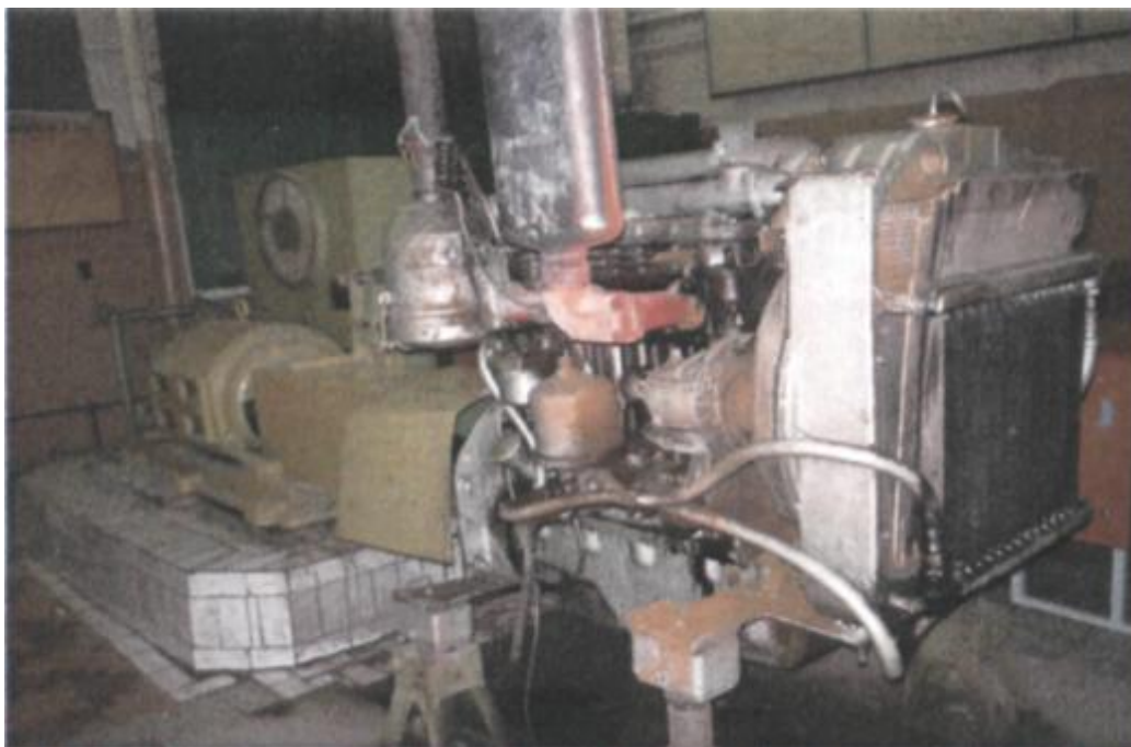
Рис. 18. Двигатель Д-240, установленный на стенде КИ-5543
