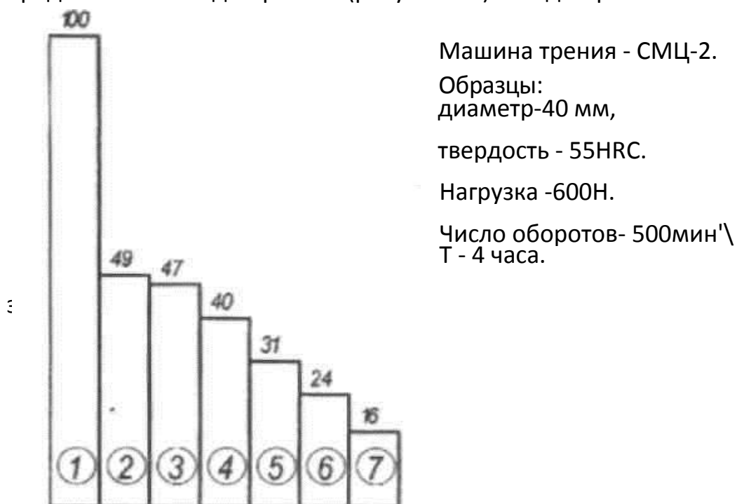
Рис. 22. Диаграмма изменения суммарного износа в процентах образца и контробразца при трении в масле с наноматериалами относительно износа образцов в чистом моторном масле, принятого за 100% 1 - Моторное масло - Лукойл SAE 10W-40, APISG/CD; 2 - Реагент-2000; 3 - Супротек универс.; 4 - Форсан; 5 - Micro-Ceramic «Wagner», 6 - RVS, 7 - Oil Package фирмы «Wagner»
